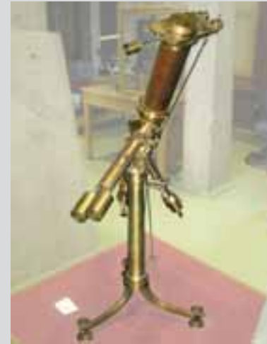
Eliometro dell'Osservatorio di Königsberg con lente da 6,2" (15,7 cm), costruito da Fraunhofer e usato da Bessel per le misure della parallasse di 61 Cygni.
